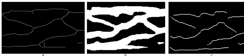
Рис. 3: Результат работы алгоритмов: (а)Зонг–Сунь, (б)Исходное изображение, (с)8-ядерный алгоритм
