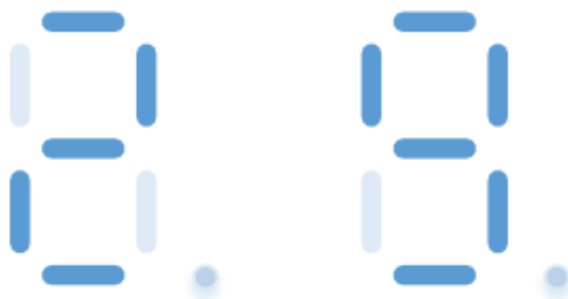
Рис. Пример изображения на семисегментном индикаторе цифр 2 и 9
